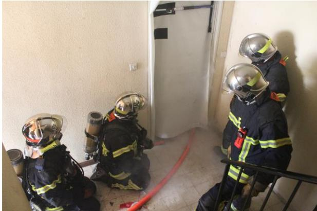
Le stoppeur de fumées est un outil désormais utilisé par les sapeurs-pompiers d'Ille-et-Vilaine afin de contenir les fumées à l'intérieur d'un logement et éviter leur propagation aux autres logements et cages d'escalier.
