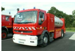
Camion Citerne Grande Capacité – CCGC (pour l'alimentation en eau sur des sinistres (+ CCGC-LC) )
