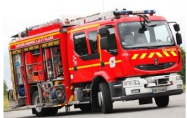
Fourgon Pompe Tonne Secours Routier – FPTSR (engin polyvalent incendie et secours routier)
