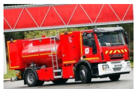
Camion Emulseur – CAEM (pour la lutte contre les feux d'hydrocarbures)
